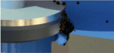
**Funzionamento irregolare delle valvole** conseguente allo sporco che può aderire tenacemente alle loro sedi e provocare sia difformità di regolazione sia trafilemanti.
