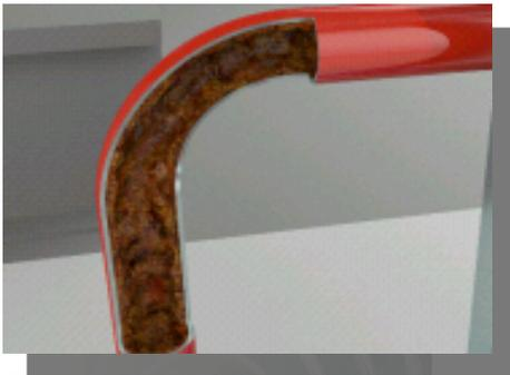
**Incrostazioni e depositi nelle tubazioni** possono ridurre sensibilmente la sezione di passaggio e quindi le portate del fluido.
