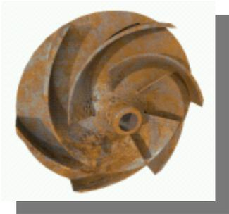
**Fenomeni di cavitazione** che possono compromettere la durata ed il funzionamento soprattutto delle pompe e delle valvole di regolazione.
